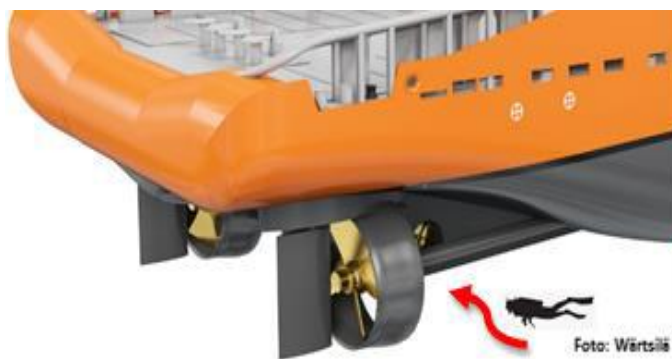
Figuur 10: Weergave van een schroefinstallatie
