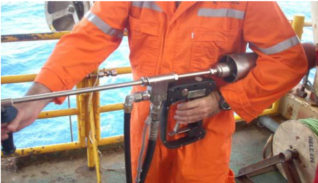
Figuur 4: Hogedrukspuit met afscherming van de retrojet venturi
